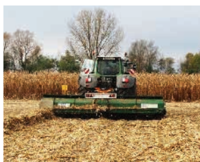
a) Sistem de recoltat nutret: combina + tractor cu masina de tocat tulpini + masina de recoltat nutret + tractor cu remorca
