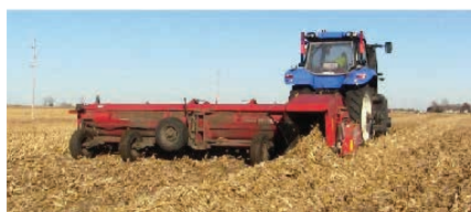
c) Combină + tractor cu mașină de tocat tulpini în șiruri + tractor cu presă de balotat
