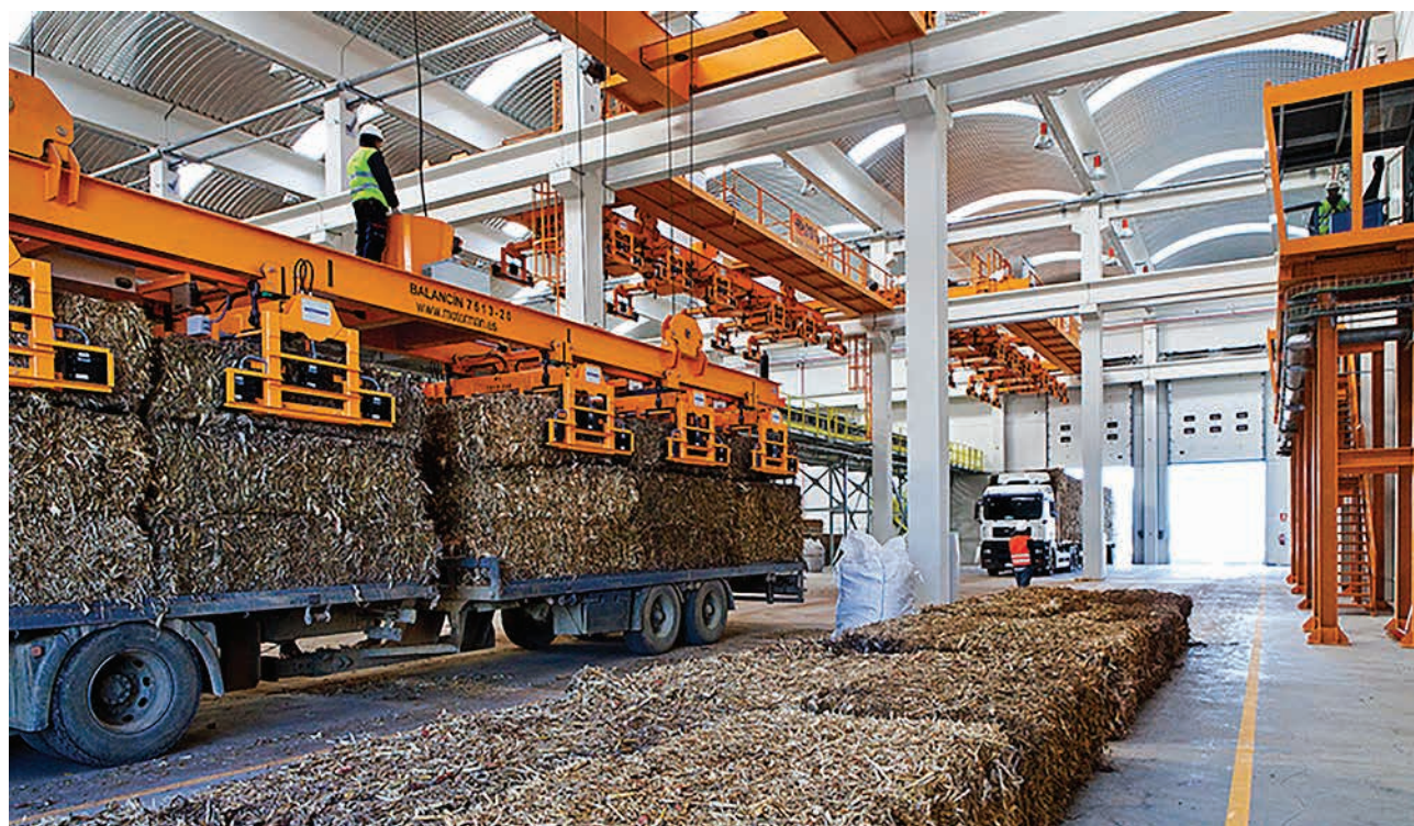
FIGURA 21: Baloți de reziduuri de porumb în depozitul de biomasă a centralei electrice Miajadas 59
