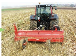
d) Combină + tractor cu tocător de tulpini + tractor cu greblă + tractor cu presă de balotat
