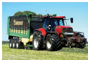
b) Sistem de vagon încărcător de furaje: combină + tractor cu mașină de tocat tulpini + tractor cu vagon încărcător de furaje
