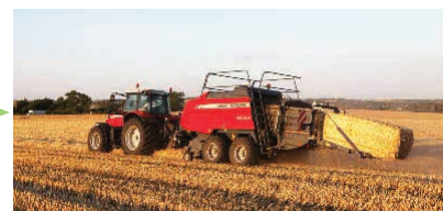
c) Combină + tractor cu mașină de tocat tulpini în șiruri + tractor cu presă de balotat
