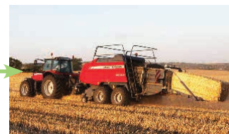
d) Combină + tractor cu tocător de tulpini + tractor cu greblă + tractor cu presă de balotat
