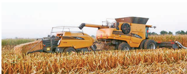
a) Sistem de recoltare cu o singură trecere: combină cu presă de balotat
