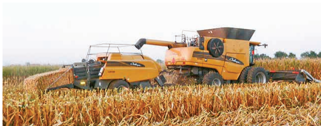
a) Jednoprohodni sustav žetve: kombajn s balirkom
