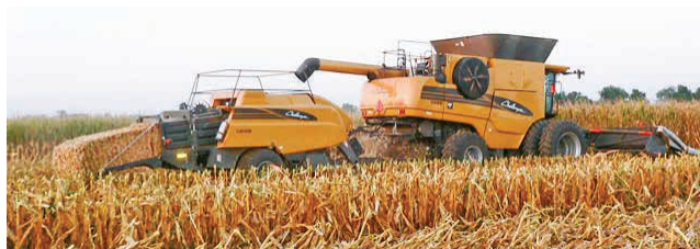
a) Récolte en un seul passage avec presse à balle
