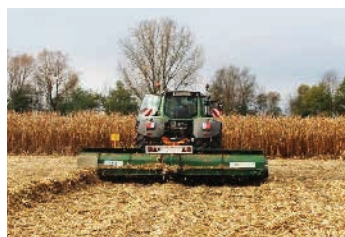
b) Système d'autochargeuse : moissonneuse-batteuse + tracteur avec andaineur déchiqueteur + tracteur avec autochargeuse
