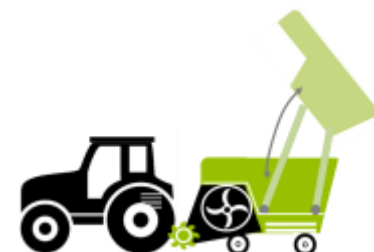
Mărunțitor remorcat cu descărcare în înălțime a containerului rabatabil încorporat
