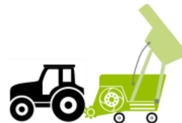
Tocător remorcat cu descărcare în înălțime a containerului rabatabil încorporat
