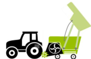
Broyeur tracté avec conteneur basculant intégré déchargeant sur la hauteur
