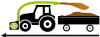
Broyeur monté à l'avant avec décharge sur remorque agricole.
