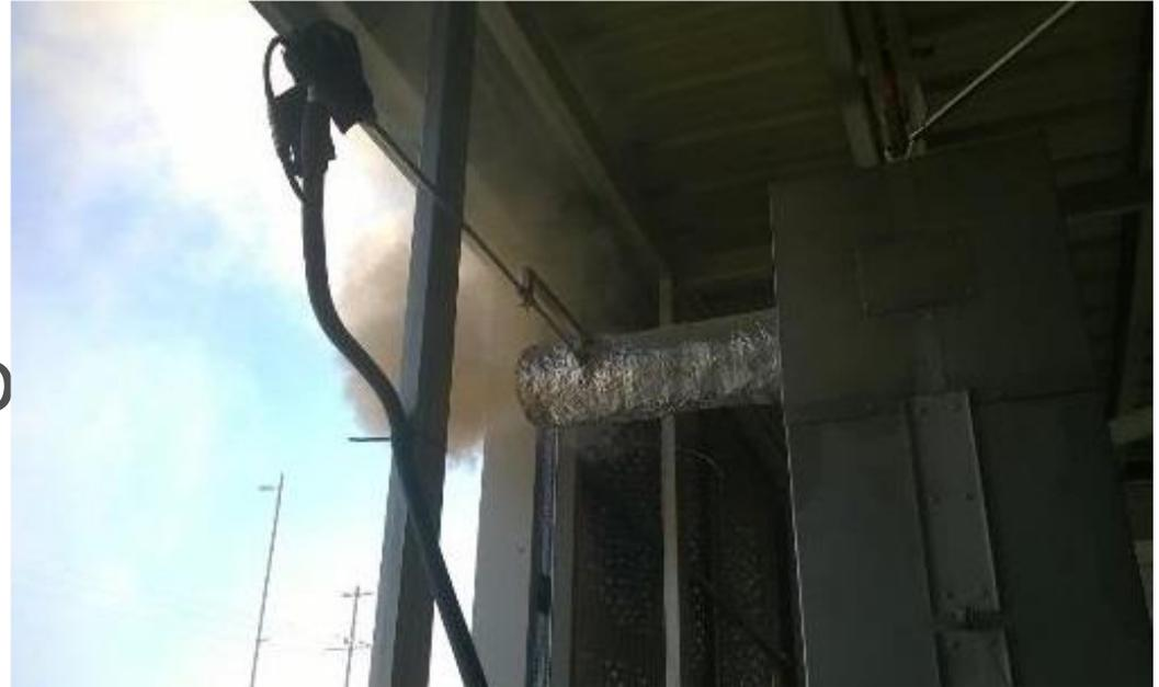
Ignición de astillas forestales con generación de gases pesados y vapor a baja temperatura.
