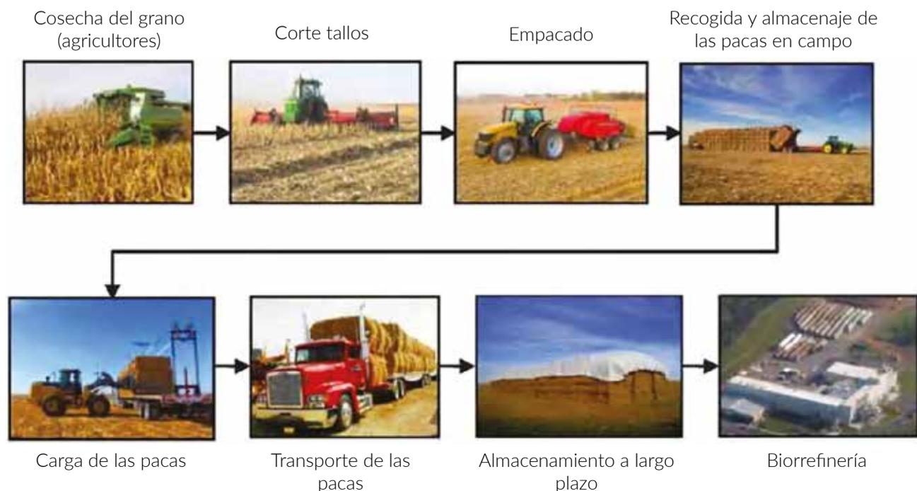
**FIGURA 14:** Modelo de planta de etanol celulósico de DuPont para la cadena de suministro de restos de cultivo de maíz<sup>36</sup>.
