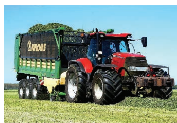
б) Система на базі кормозбирального причепа-підбирача: зернозбиральний комбайн + трактор з мульчувачем-валкоутворювачем + трактор з кормозбиральним причепом-підбирачем
