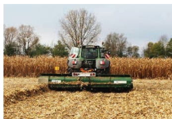
б) Система на базі кормозбирального причепа-підбирача: зернозбиральний комбайн + трактор з мульчувачем-валкоутворювачем + трактор з кормозбиральним причепом-підбирачем
