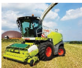
а) Система на базі кормозбирального комбайна: зернозбиральний комбайн + трактор з мульчувачем-валкоутворювачем + кормозбиральний комбайн + трактор з причепом
