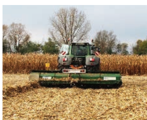
а) Система на базі кормозбирального комбайна: зернозбиральний комбайн + трактор з мульчувачем-валкоутворювачем + кормозбиральний комбайн + трактор з причепом
