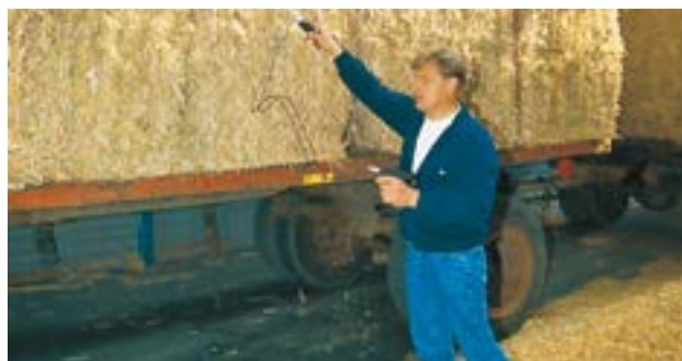
El contenido de humedad en la paja se controla antes de la descarga. Si el contenido de agua es superior al 25%, normalmente se rechaza.
