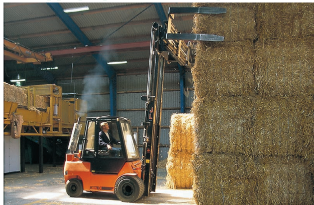
Τα δεμάτια αχύρου τοποθετούνται σε προσωρινή αποθήκη με ένα περνοφόρο όχημα. Τα δεμάτια πρέπει να εκφορτωθούν και να τοποθετηθούν εντός της περιοχής με κίτρινη ένδειξη, έτσι ώστε ο γερανός να μπορεί να συλλέγει αυτόματα τα δεμάτια από την αποθήκη. ΦΩΤΟΓΡΑΦΙΑ Torben Skøtt, BioPress.
