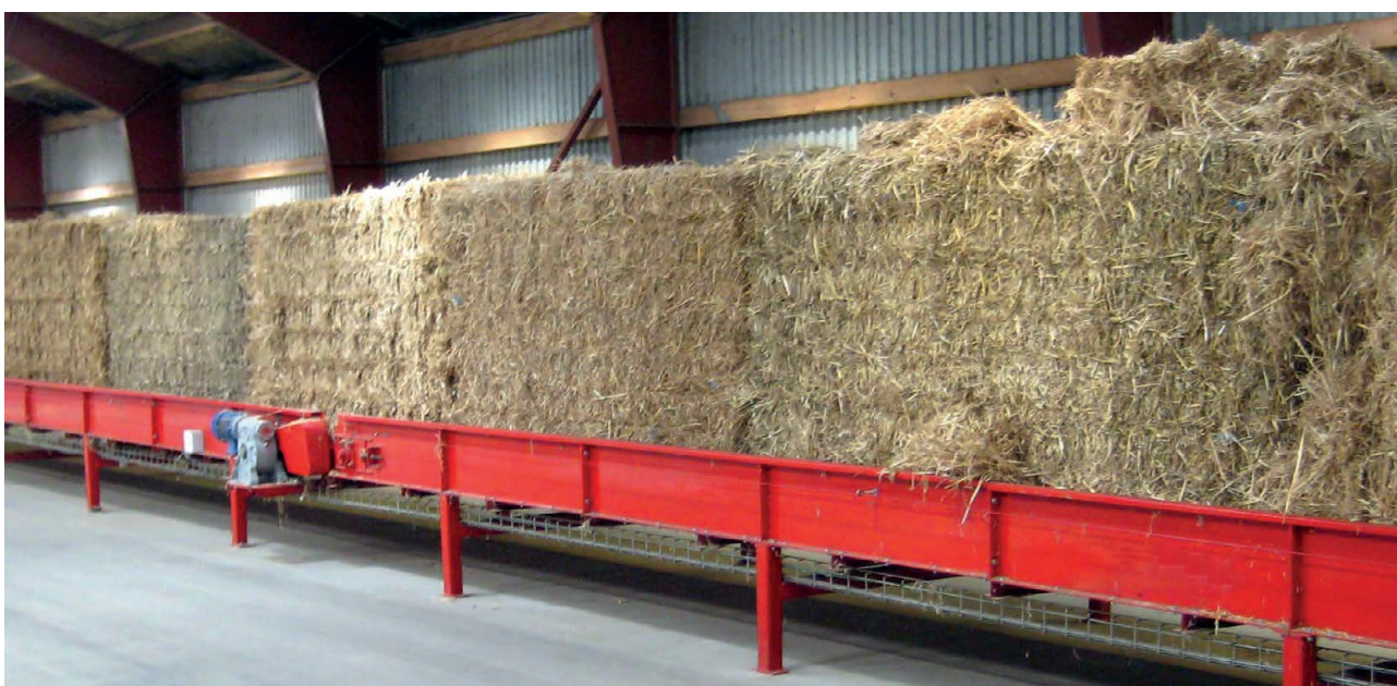
Μεταφορέας άχυρου για αυτόματη φόρτωση. ΦΩΤΟΓΡΑΦΙΑ Cormall A/S.
