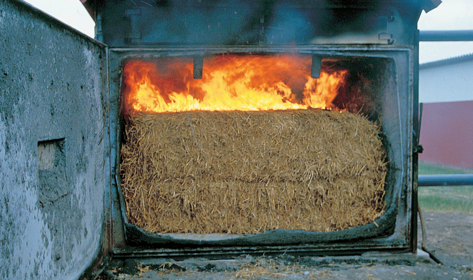
Λέβητας τμηματικής τροφοδοσίας αχύρου για μεγάλα δεμάτια. ΦΩΤΟΓΡΑΦΙΑ Torben Skøtt, BioPress.
