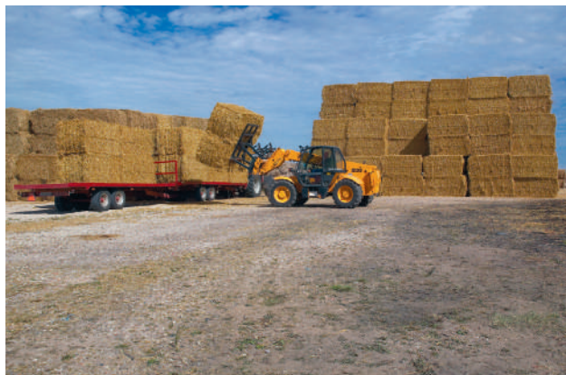
Istovremeni istovar dviju bala slame teleskopskim utovarivačem smanjujući radni teret. SLIKA Torben Skøtt, BioPress.
