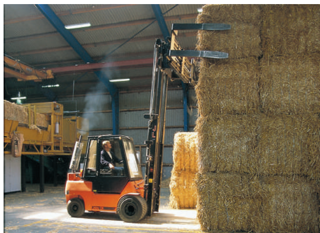
Bale slame se viličarima stavljaju u spremišta/skladišta. Bale se moraju iskrcati i smjestiti u područje označeno žutom bojom, tako da dizalica može automatski skupljati bale iz skladišta.
