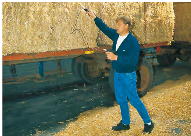
Conținutul de umiditate din paie este controlat înainte de descărcare. Dacă conținutul de apă este peste 25%, acesta este în mod normal respins.
