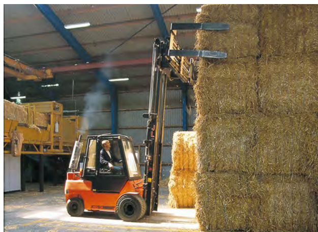
Baloturile de paie sunt așezate în depozitul tampon cu un stivuitor. Baloturile trebuie descărcate și plasate în zona marcată cu galben, astfel încât macaraua să poată colecta automat baloturile din spațiul de depozitare. Fotografie Torben Skøtt, BioPress.
