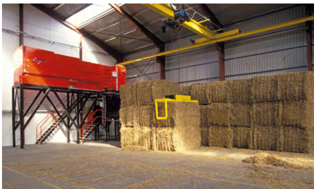
Depozitul de paie de la centrala de termoficare Terndrup. Transportul de la magazie la cazan are loc cu o macara controlată automat. Depozitul poate conține paie pentru aproximativ o săptămână de funcționare pe timpul iernii. Fotografie Torben Skøtt, BioPress.
