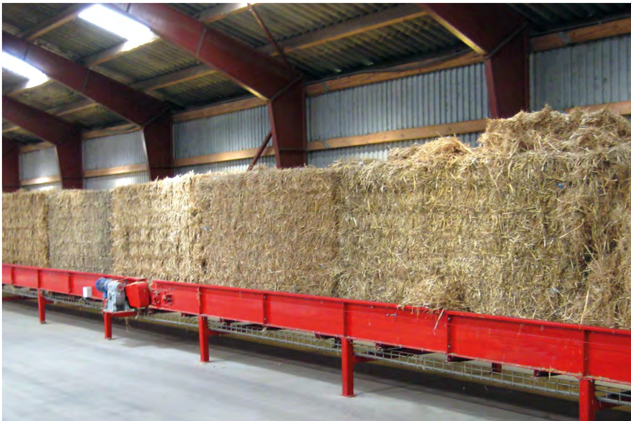
Transportor de baloturi de paie pentru încărcare automată. Fotografie Cormall A/S.
