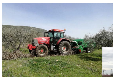
Recolección integrada de poda y trituración en un olivar
