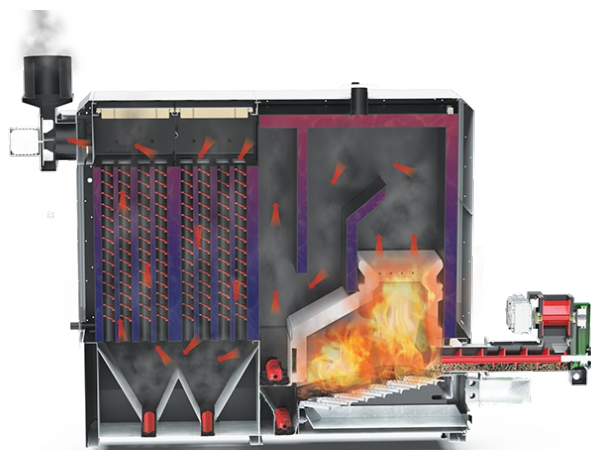
Сучасний котел з рухомою колосниковою решіткою та автоматичною системою очищення теплообмінника
